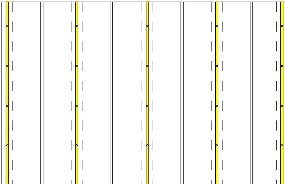
Längslatten: Dimensionierung des Lattenquerschnittes hat unter Bezug der aktuellen normativen Regelungen zu erfolgen. Aufgrund der Dachsteinform und der Einhängenase (kein durchgehender Einhängesteg!) können in der Dimensionierung durchschnittlich 2cm Hinterlüftung oberhalb der Querlattung als Längsbelüftung zum Bemessungsquerschnitt dazugerechnet werden.
