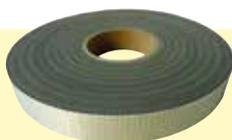
zur Abdichtung zwischen aufgehendem Mauerwerk und der Wärmedämmung - im eingebaute Zustand auf ca. 30 % komprimieren, imprägniert und einseitig selbstklebend
